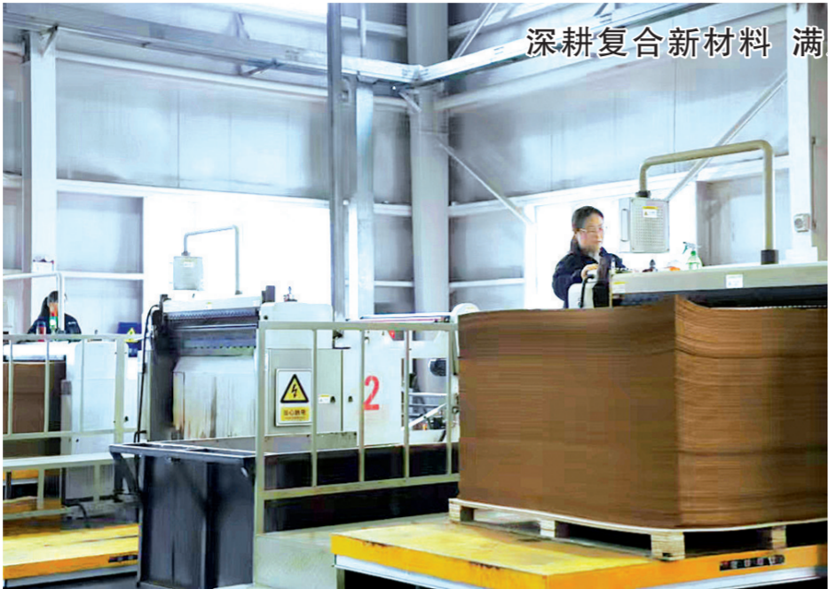
位于市城乡一体化示范区(高新区)的河南汇森农林科技有限公司以可再生栓皮栎树皮为原料,研发生产软木生物基新材料,以先进的企业文化为理念,根植于国际前沿的软木复合新材料领域,生产和研发的软木复合新材料深受用户青睐,市场前景广阔。图为4月15日,工人在加工软木纸。
