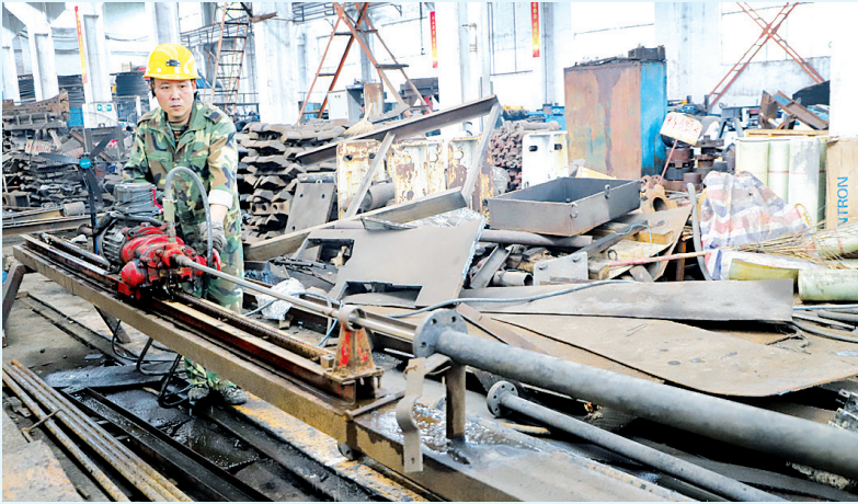
工人正在使用专用工具疏通高压水管。
