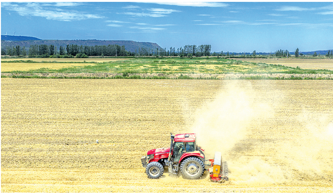
这种旋耕施肥播种机可同时完成旋耕、播种、施肥、铺管一体化作业。
