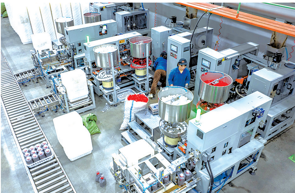
4月8日,在卢氏县珍稀食用菌生产基地建设项目现场,自动装袋机正在作业。 杜杰 摄
