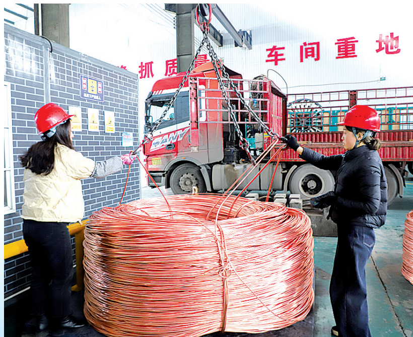
市城乡一体化示范区(高新区)三门峡汇盛铜业有限公司生产车间,工作人员正在对刚生产的铜杆卷进行检测称重。本报记者 徐洪波 摄
