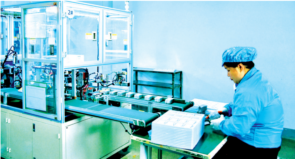
7月24日,在位于渑池县锂电科技产业园内的河南普德新能源科技有限公司,工人正在生产车间对锂电池进行开路电压测试,确保电池质量稳定可靠。据悉,该县锂电产业已呈现出龙头项目带动、骨干项目落地、配套项目集聚的良好发展态势,助力县域经济高质量发展。 王凯锐 摄
